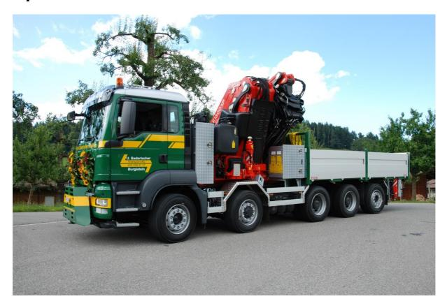
Der niedrige Aufbau erlaubt das Transportieren von Gütern bis zu 2.80 m Höhe. Eine 3 Tonnen Seilwinde erlaubt ein schnelles Aufziehen von Holz- und Stahlkonstruktionen. Der Zusatzknickarm hat eine Hubkapazität von 8 Tonnen. Besonders geeignet für:
